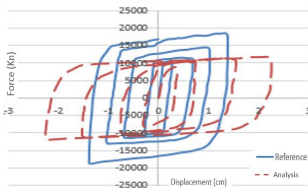
شکل ۳۹: مقایسه‌ی منحنی هیستریزیس صفحه‌ی اتصال نمونه‌ی منحنی شکل و نمونه‌ی مرجع.
