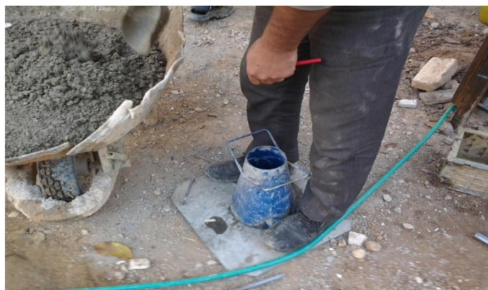
شکل ۱۳: حضور مسئول آزمایشگاه بتن و انجام آزمایش اسلامپ برای تعیین میزان روانی بتن.
