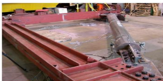
شکل ۱۵: نمونه‌ی مهاربند کمانش تاب آزمایش شده توسط ترمبلی و همکاران [۳۲].
