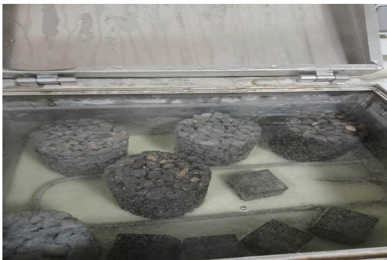
شکل ۳: نمونه های استوانه‌ای از بتن متخلخل و عمل آوری آنها در آزمایشگاه.
