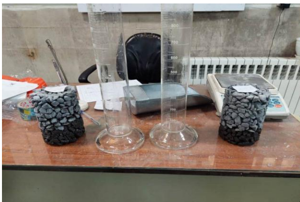
شکل ۱: نمونه‌های مکعبی ساخته شده.
