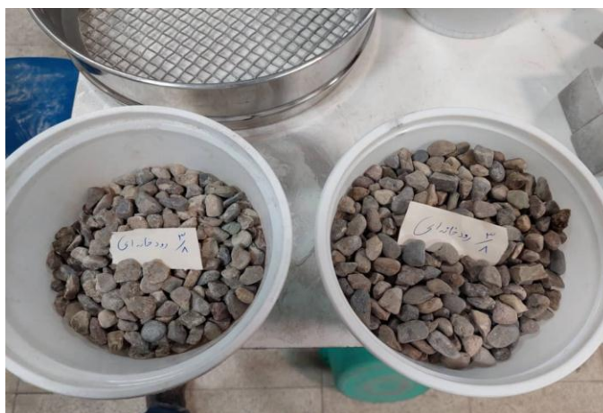
شکل ۲: مصالح مورد استفاده در ساخت بتن متخلخل.
