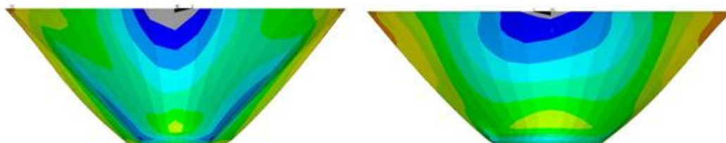
شکل ۹: تنش اصلی حداکثر رویه بالادست بدنه (سمت راست) و تنش اصلی حداکثر رویه پائین دست بدنه (سمت چپ).
