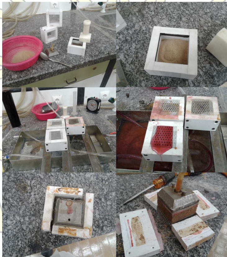
شکل (۱۲): تصویر نمونه‌سازی تزریق نانو سیلیکای کلونیدی برای آزمایش برش مستقیم
