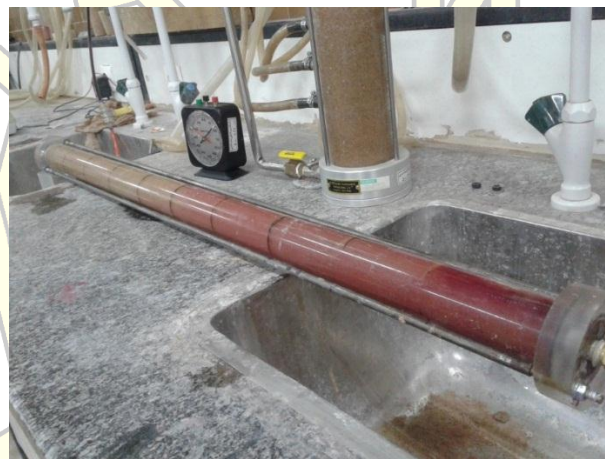
شکل (۷): لوله تزریق به طول ۱ متر و قطر ۴ سانتیمتر
