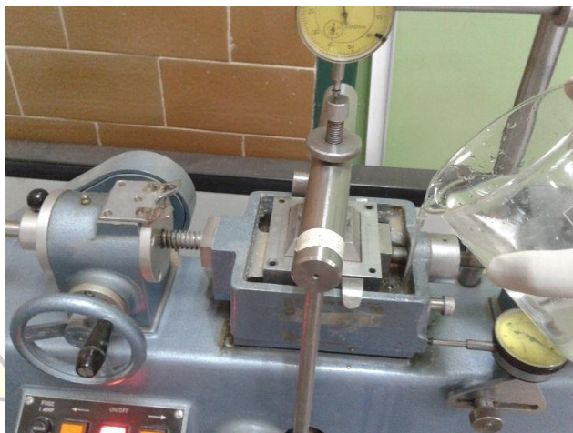
شکل (۱۳): انجام آزمایش برش مستقیم بر روی نمونه‌های مورد مطالعه در حالت اشباع
