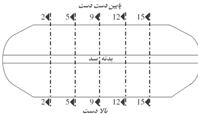
شکل (۲): پلان شماتیک موقعیت مقاطع ابزاربندی سد
