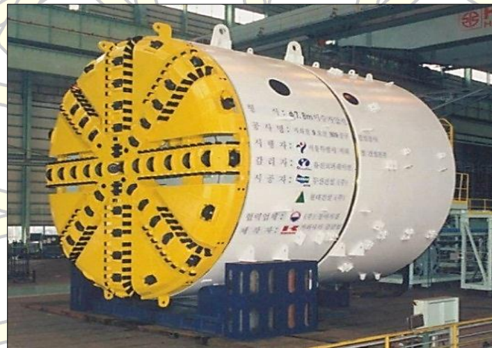
شکل ۱۲: ماشین حفاری خط ۹ متروی سنول
