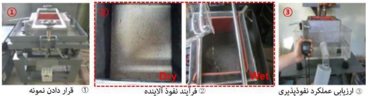
شکل ۴: فرایند روش نفوذ آلاینده و آزمایش نفوذپذیری.
