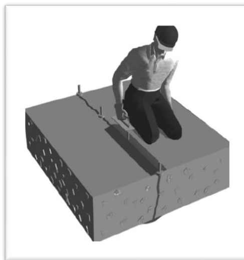
شکل ۵: ایجاد لایه درپوش برای جلوگیری از خروج مواد تزریقی.
