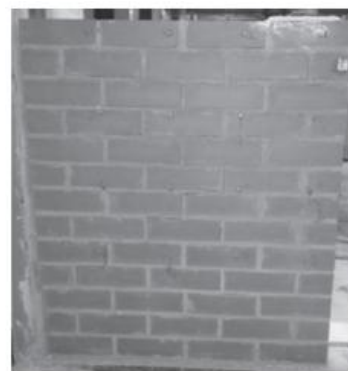
شکل ۲: نمونه ی دیوار آجری تک لایه با ملات [۱۹].
