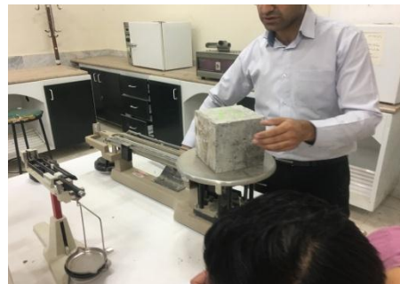
شکل ۳: وزن کردن و اندازه گیری نمونه های بتنی در آزمایشگاه.
