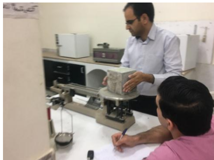
شکل ۳: وزن کردن و اندازه گیری نمونه های بتنی در آزمایشگاه.
