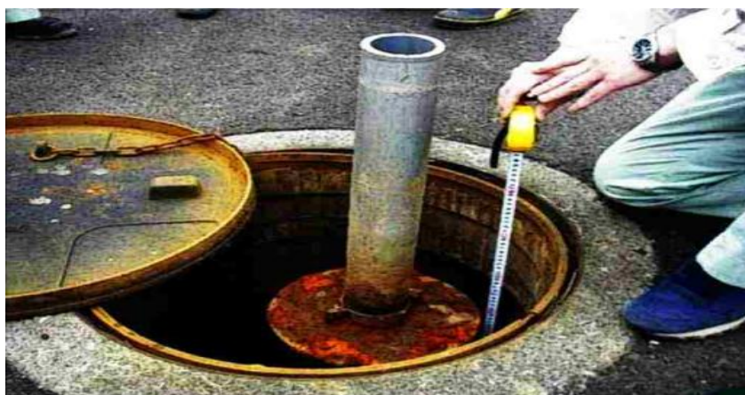
شکل ۴: دستگاه نشست سنج (یاماگوچی و همکاران، ۲۰۰۸) [۳۵].
