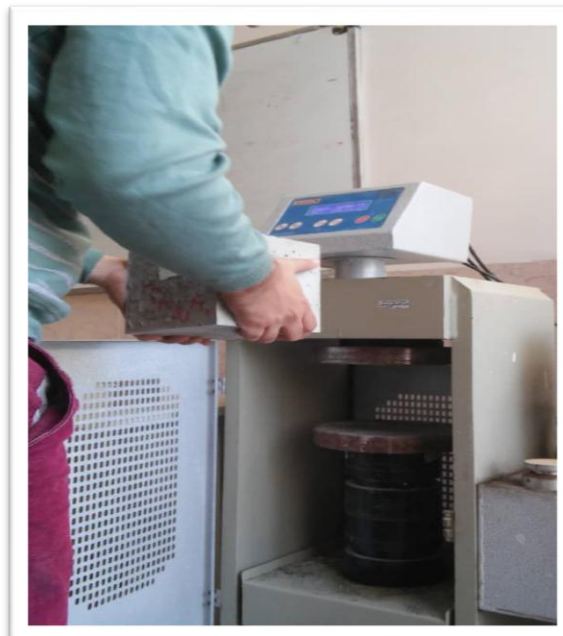
شکل ۲: تصویر قرارگیری نمونه های بتنی مکعبی در دستگاه.
