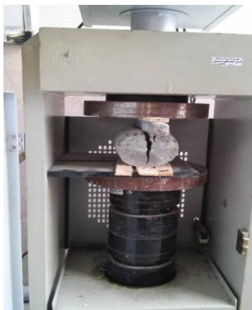
شکل ۱۳: زمان اعمال فشار نمونه های استوانه ای درون دستگاه.
