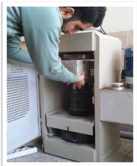
شکل ۲: تصویر قرارگیری نمونه های بتنی مکعبی در دستگاه.
