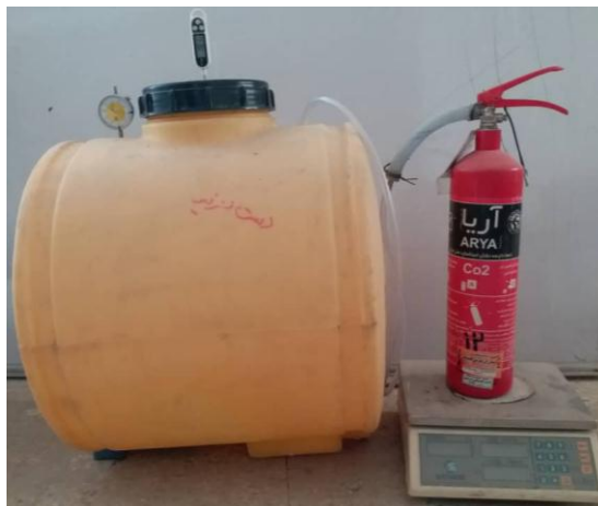
شکل ۲: مخزن نگهداری نمونه ها تحت فشار گاز دی اکسید کربن.
