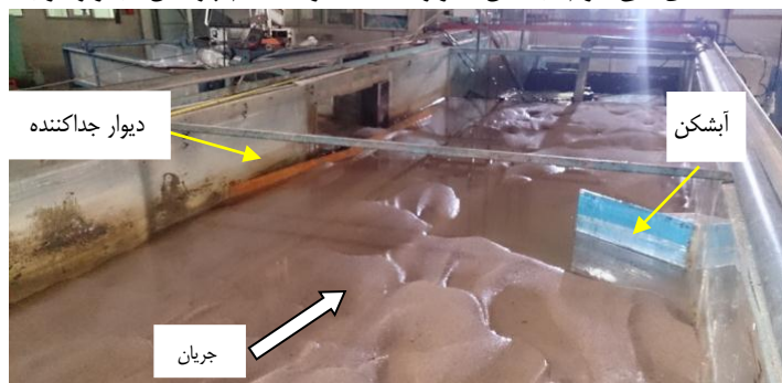
شکل ۲: نمای فلوم، آبشکن، دیوار جداکننده جلوی دهانه آبگیر.
