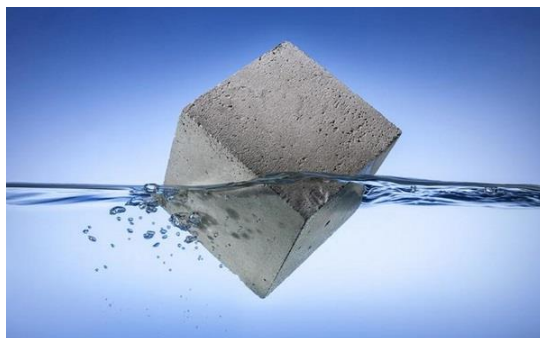
شکل ۵: نمونه ای از بلوک بتنی سبک
