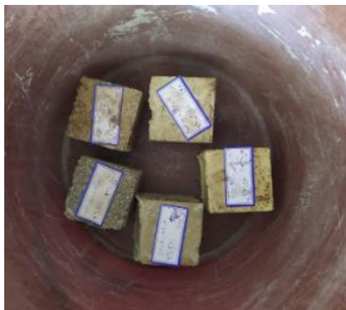
شکل ۳: تعدادی از نمونه‌ها در حال آزمایش جذب آب
