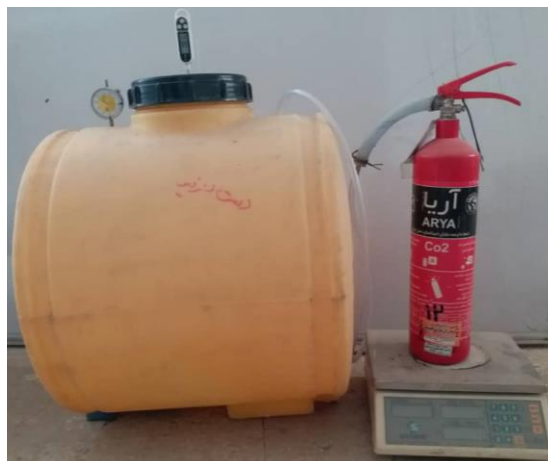
شکل ۴: مخزن نگهداری نمونه‌ها تحت فشار گاز دی اکسید کربن
