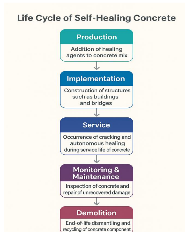
شکل ۴: چرخه عمر عملکردی بتن خودترمیم‌شونده در ساختارهای عمرانی
