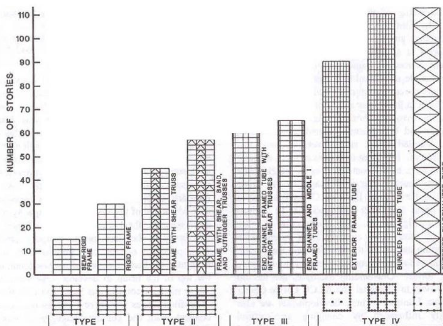
شکل ۱: سامانه‌های مهار جانبی برای تعداد طبقات مختلف [۵].
