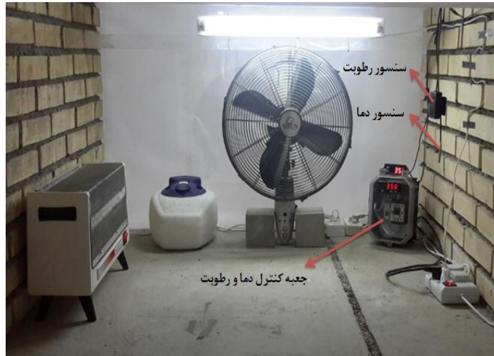
شکل ۴: اتاقک کنترل رطوبت و دما.
