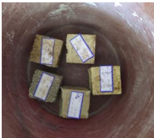
شکل ۶: تعدادی از نمونه ها در حال آزمایش جذب آب.
