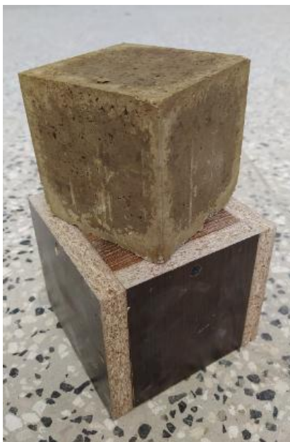
شکل ۳: قالب چوبی و نمونه بتن خشک گوگردی.
