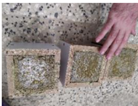
شکل ۴: بتن گوگردی مذاب درون قالبها.
