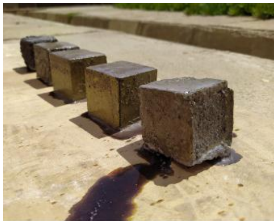
شکل ۵: نمونه های خارج شده از اسید سولفوریک.
