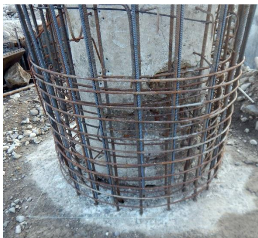
شکل ۲۳: کاشت میلگرد در پایه پل مدل آزمایشگاهی.
