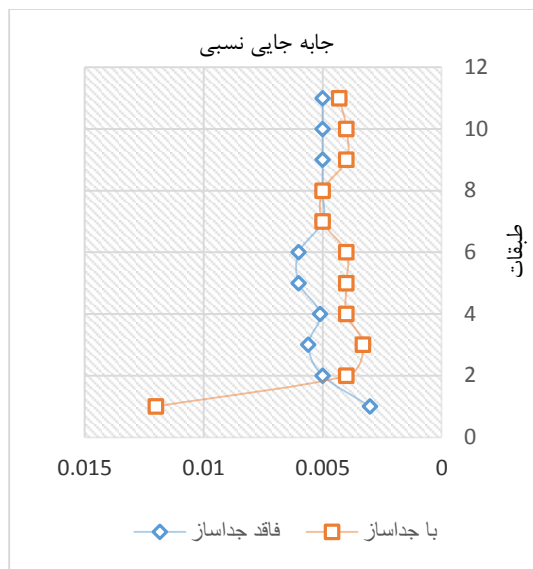
شکل ۷: مقایسه جابه جایی نسبی قاب مهاربندی شده یازده طبقه دارای جداساز و بدون جداساز.
