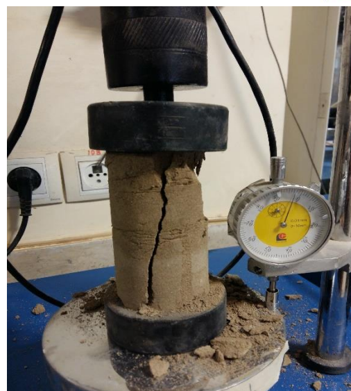
شکل ۳: شکست نمونه‌ها در آزمایش مقاومت فشاری تک محوری
