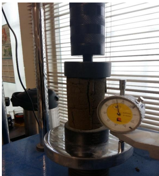
شکل ۳: شکست نمونه‌ها در آزمایش مقاومت فشاری تک محوری
